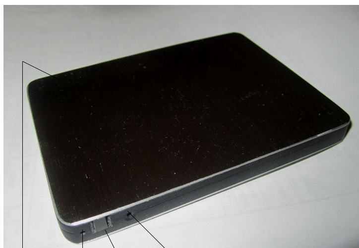
USB РАЗЪЕМ RESET КНОПКА ЗАПИСИ-СВЕТОДИОД МИКРОФОН
